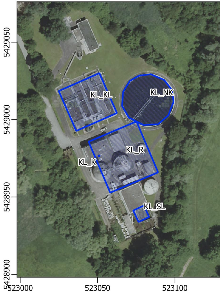
Abb. 5-6: Übersicht mit Emissionsquellen der Kläranlage B5 nördlich des Plangebiets. Die blauen Markierungen bezeichnen die einzelnen Emissionsquellen, die Abkürzungen entsprechen den im Text verwendeten Bezeichnungen für die einzelnen Quellen (Luftbild: © www.lgl-bw.de).
