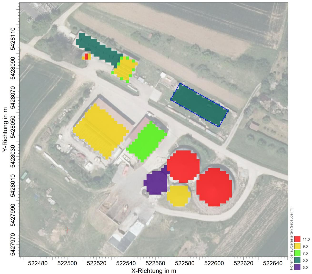
Abb. 7-4: Aufrasterung der Gebäude der Biogasanlage B1 und der Schweinehaltung B2. Das blau umrandete Gebäude des Betriebs B7 wird nur in der Ausbreitungsrechnung „Planfall 02“ berücksichtigt (Luftbildgrundlage: onmaps.de © GeoBasis-DE/BKG 2023 © Hexagon).
