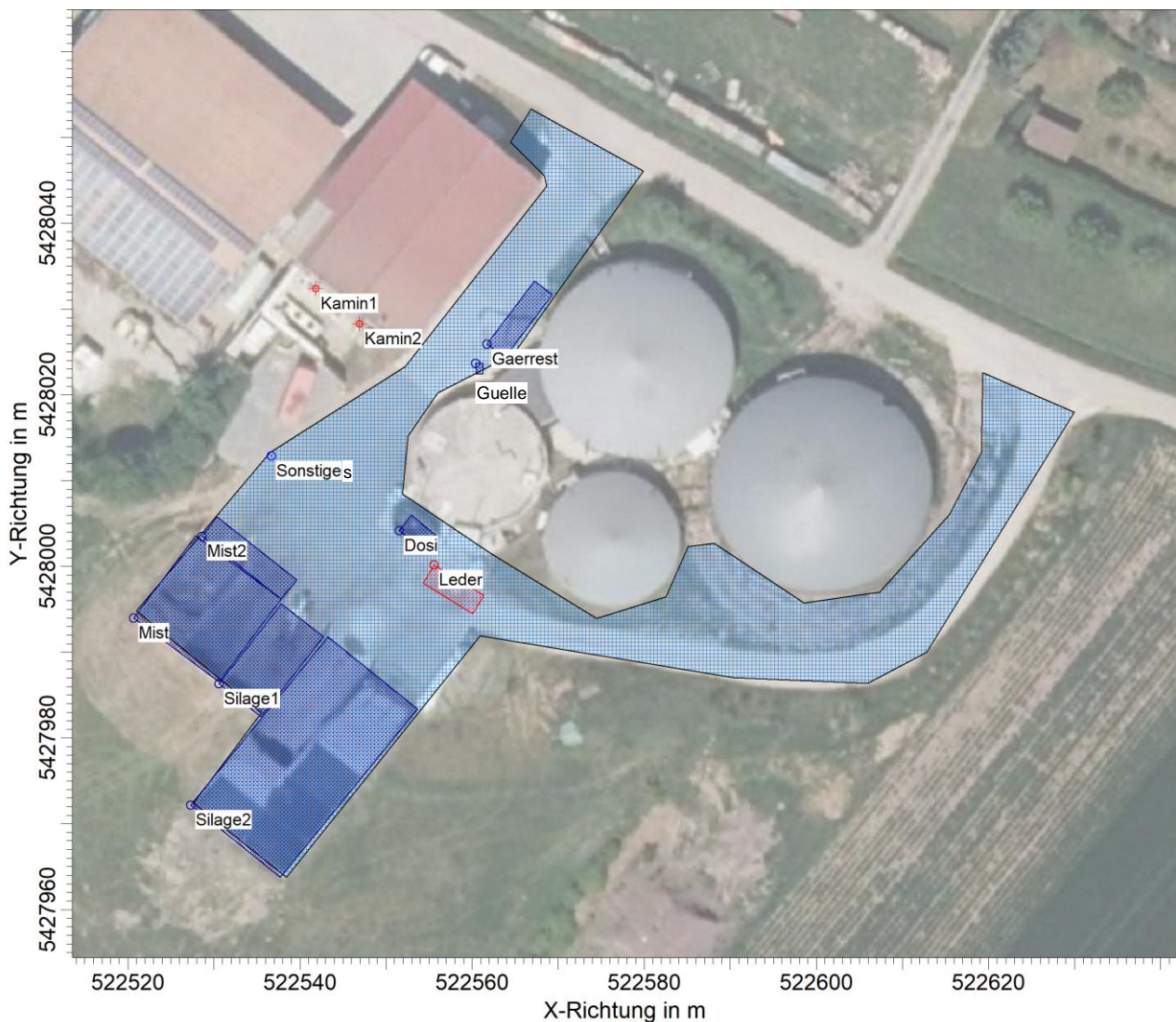
Abb. 5-2: Übersicht mit Emissionsquellen der Biogasanlage im Plan-Zustand. Die blauen bzw. roten Markierungen bezeichnen die einzelnen Emissionsquellen, die Abkürzungen entsprechen den im Text verwendeten Bezeichnungen für die einzelnen Quellen. (Luftbildgrundlage: onmaps.de © GeoBasis-DE/BKG 2022 © Hexagon).
